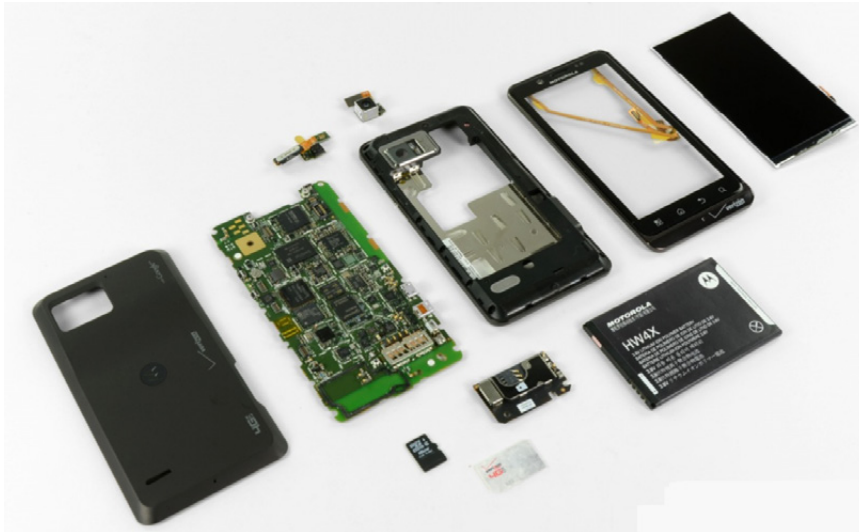
Abb. 1–2 Komponenten eines Smartphones
