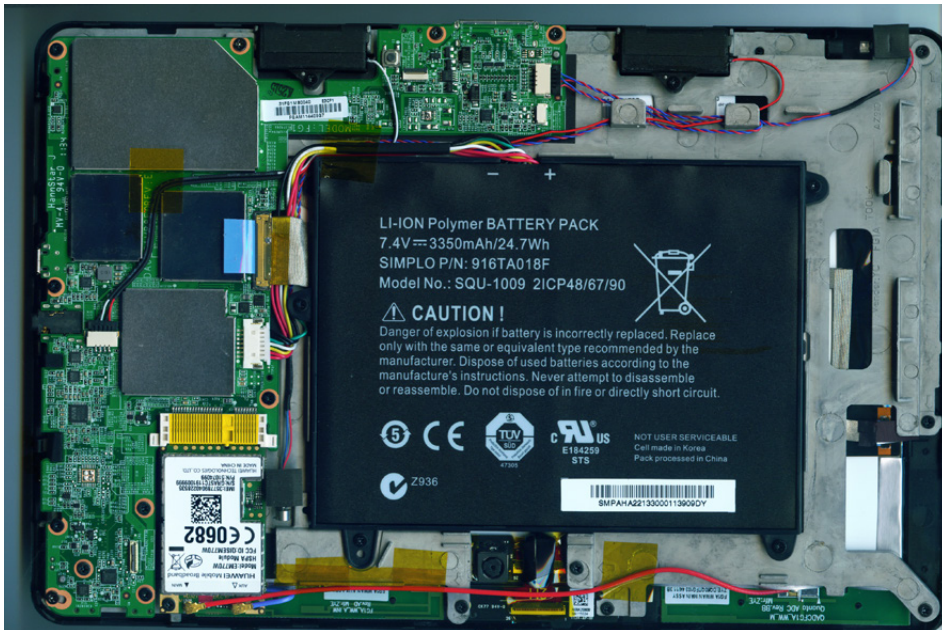
Abb. 1–10 Dieser spezielle Akku in diesem Tablet ist recht flach, nimmt dafür jedoch recht viel Platz ein.
