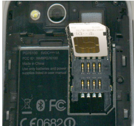
Abb. 1–5 Bei diesem Smartphone wird die SIM-Karte in einen Rahmen gesteckt, der dann herunter in die Arretierung zu drücken ist.
