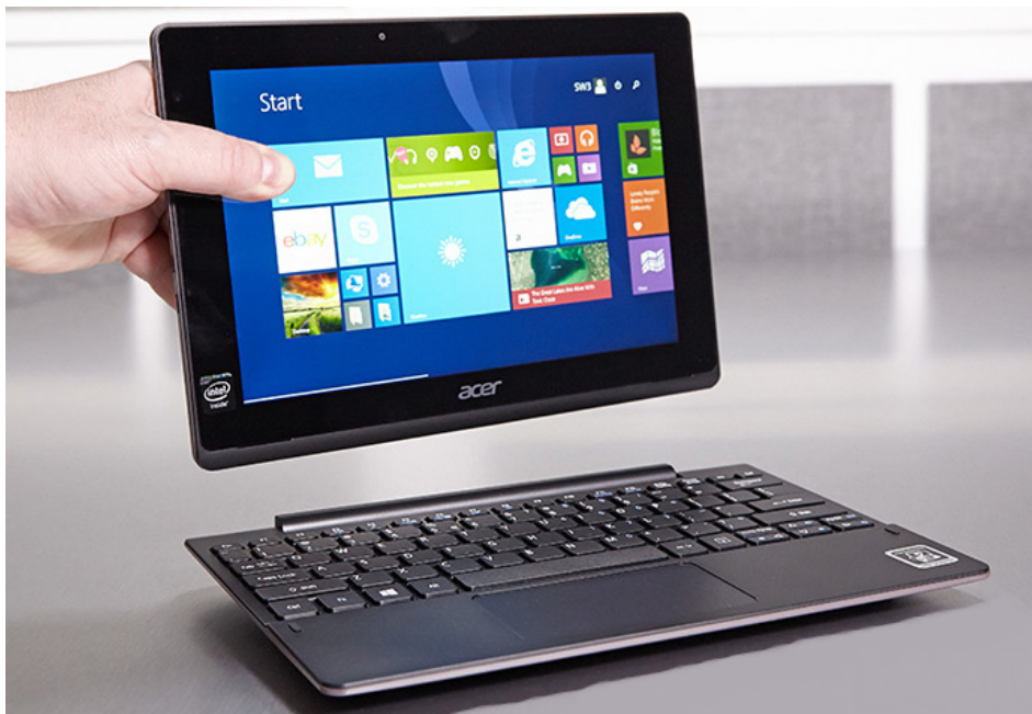
Abb. 1-7 Convertibles oder Multi-Mode-Notebooks wie die Switch-Modelle der Firma Acer sind sowohl Tablet als auch Notebook und erlauben demnach beide Bedienungsprinzipien.
