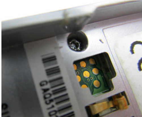
Abb. 4–5 Mit dem unpassenden Werkzeug ist eine Schraube schnell beschädigt, sodass sie sich dann nur noch mühsam oder gar nicht mehr lösen lässt.
