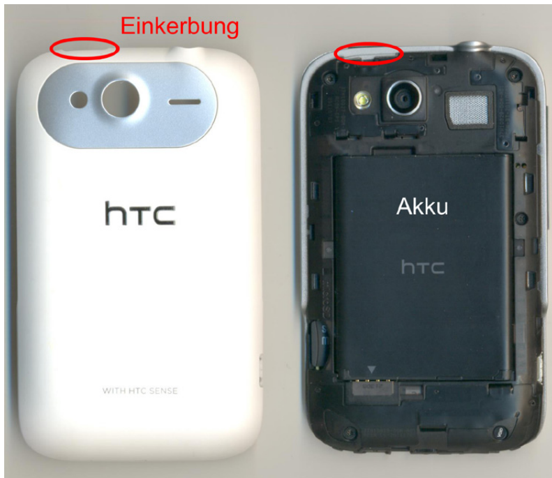
Abb. 4-7 Das Abnehmen der Rückwand ist meist ohne Werkzeug möglich, wenn man die Einkerbung beachtet.
