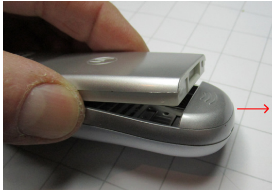
Abb. 4–1 Einfacher und schneller geht es kaum: Verriegelung nach rechts ziehen und den Deckel abheben.
