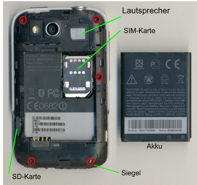
Abb. 4–8 Nach dem Akku sind fünf Schrauben sowie die SIM- und die SD-Karte zu entfernen.
