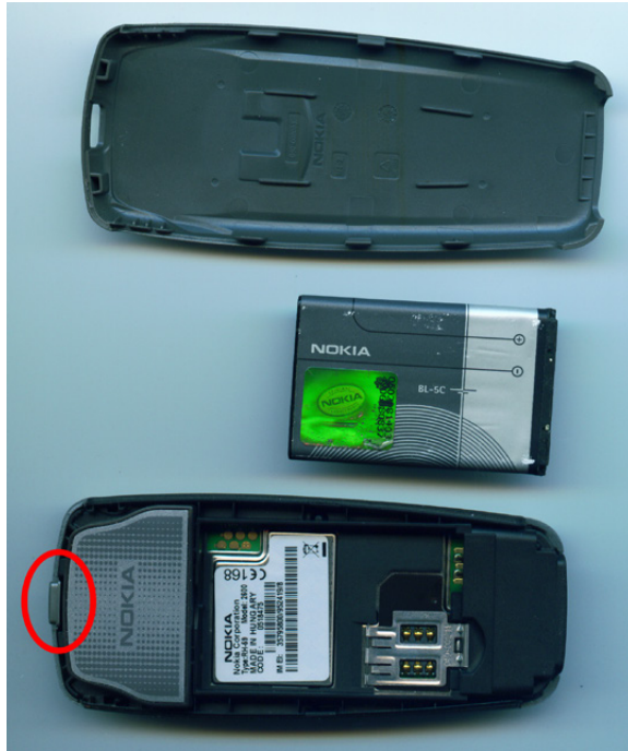
Abb. 4-3 Nach dem Eindrücken der Verriegelung lassen sich Vorder- und Rückseite voneinander trennen und abnehmen.
