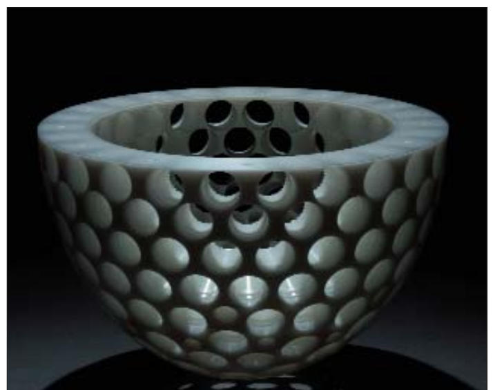
Optimierte Halterung für die Ultraschall-Sensoren – die dann ein dreidimensionales Bild der Brust ermöglichen. Foto: Markus Breig
