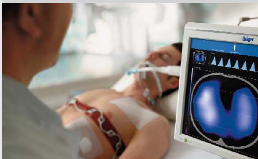
PulmoVista 500: Der Monitor zeigt am Patientenbett anhand von Bildern, Kurven und Parametern, wie sich die Ventilation regional in der Lunge verteilt (Foto: Dräger).
