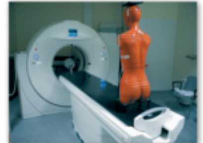
Konstanzprüfung an allen CT-Systemen
