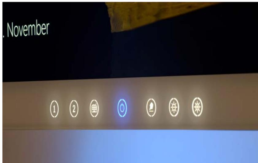
Der MLC 8 von Adlink Technology hat Buttons, die beim Wechsel zwischen hoch- und querformatiger Monitoransicht automatisch mitwandern und immer unten stehen
